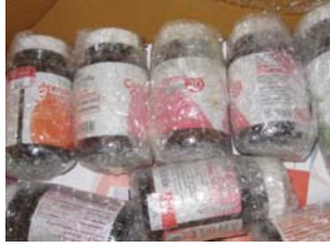
รูปที่ 2.9 ตัวอย่างตัวดูดซับสารเคมีและวัสดุกันกระแทก ที่ใช้ในการกั้นระหว่างขวดสารเคมีขณะเคลื่อนย้าย
