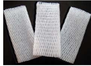
รูปที่ 2.9 ตัวอย่างตัวดูดซับสารเคมีและวัสดุกันกระแทก ที่ใช้ในการกั้นระหว่างขวดสารเคมีขณะเคลื่อนย้าย
