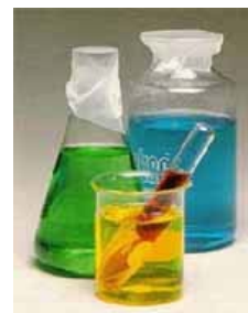
รูปที่ 2.5 การใช้แผ่นพาราฟิล์มปิดฝาภาชนะ
