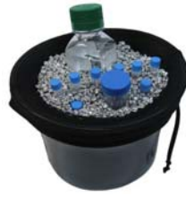
รูปที่ 2.9 ตัวอย่างตัวดูดซับสารเคมีและวัสดุกันกระแทก ที่ใช้ในการกั้นระหว่างขวดสารเคมีขณะเคลื่อนย้าย
